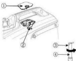
2. Inserire il manubrio ③ nell'utensile ④ e ruotarlo in senso antiorario per rimuovere la candela.
