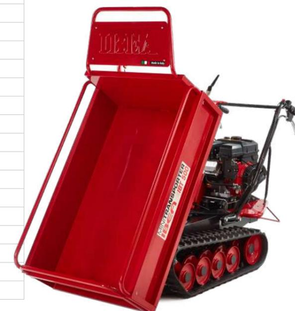
Il cambio a 5 rapporti (3 marce avanti e 2 retro) è il cuore di ogni Minitransporter. È sovradimensionato per poter gestire nella massima sicurezza le enormi coppie generate dal motore. Grazie all'efficiente demoltiplica, i Minitransporter hanno la capacità di muoversi in ogni situazione e sotto ogni carico.
