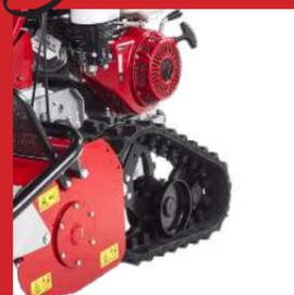
I cingoli in gomma fanno di questa serie di macchine la scelta perfetta per condizioni di lavoro estremamente gravose ed inaccessibili ad altri tipi di macchine.
