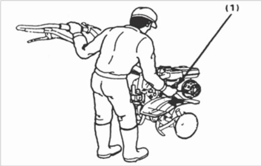
7.1.7 Quando il motore si scalda, aprire l'aria gradualmente.
